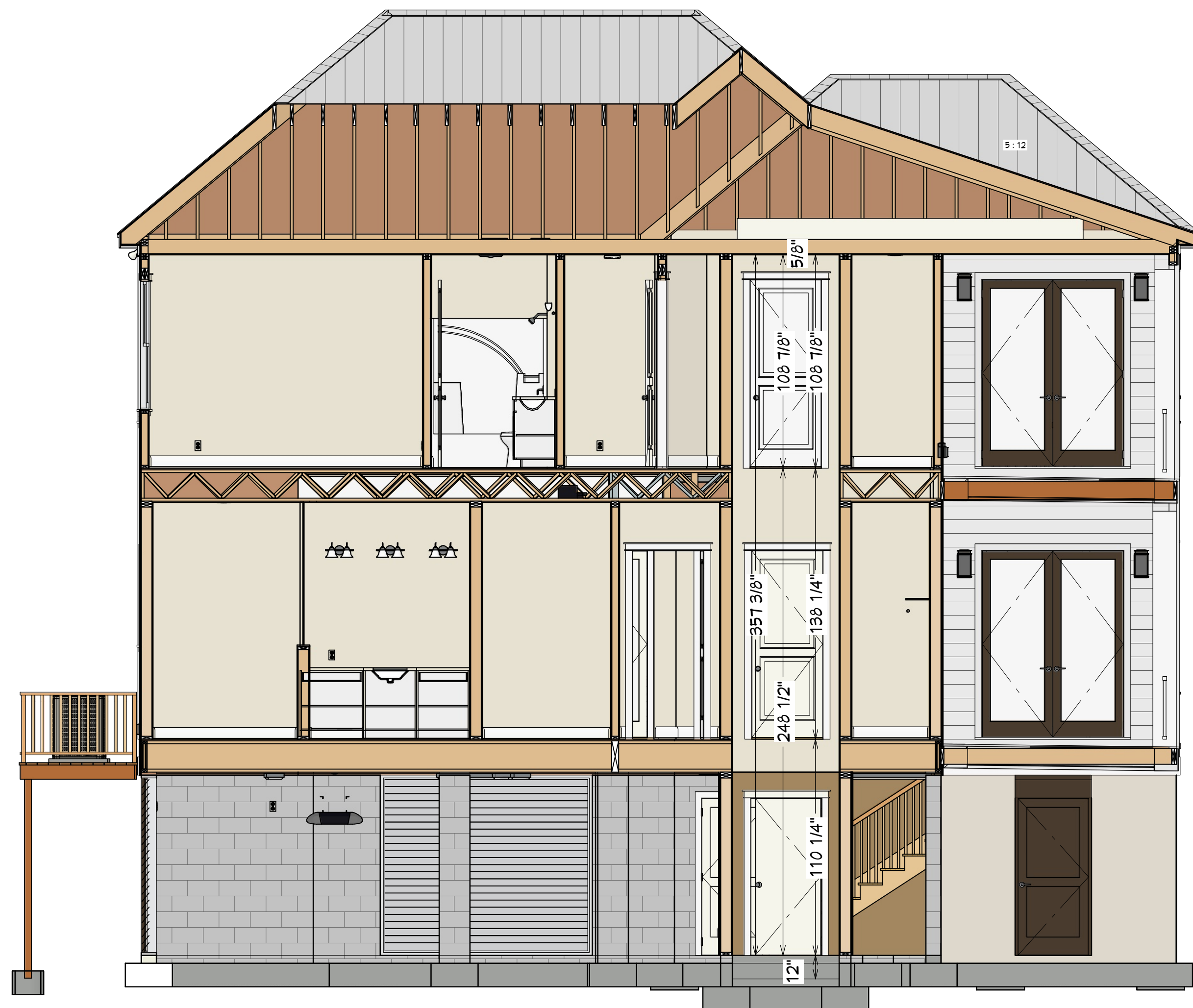
2 A6 Elevator Shaft
